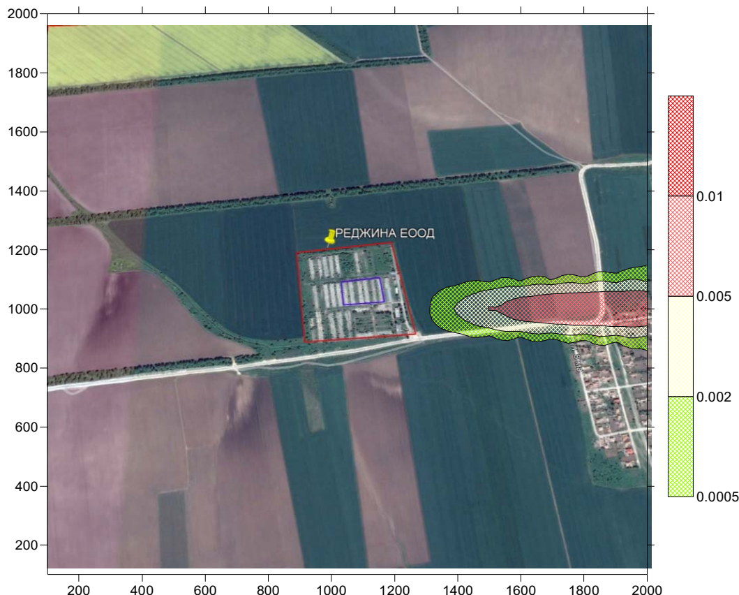
Фиг. 33 Изолинии на максимални еднократни приземни концентрации на амоняк от вентилационните системи на производствените сгради
